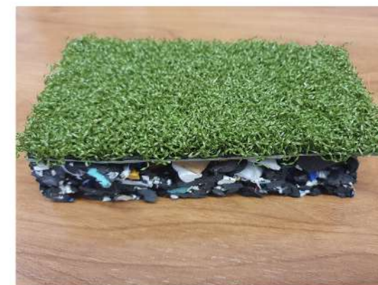
PAVIMENTO ABSORBE IMPACTO RECUBIERTO CON CESPED ARTIFICIAL
